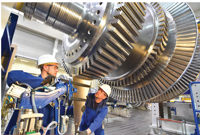
FIGURA 1.1 Ensamble industrial de una turbina de vapor, tecnología fundamentada en los principios de la conversión y transferencia de energía.
